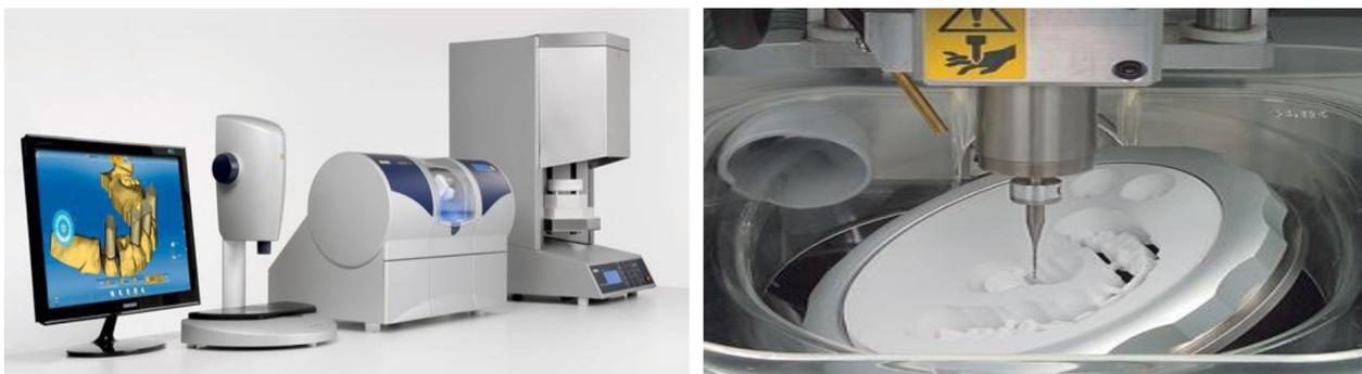
Gambar 2. Mesin CAD/CAM dan Mesin Milling
