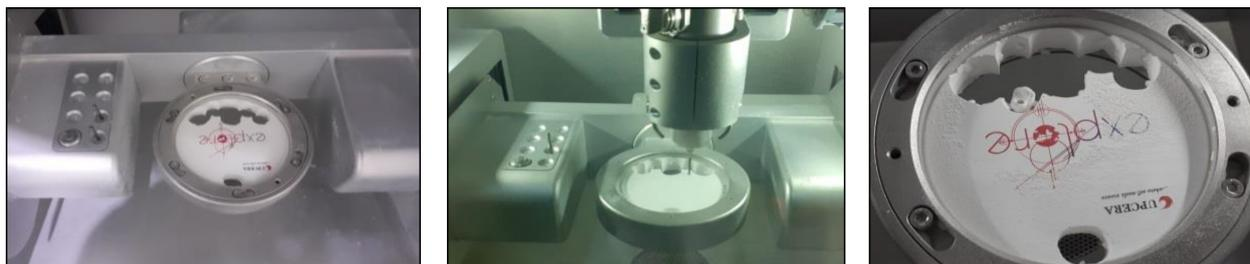
Gambar 5. Proses menempatkan *Block Zirconia* ke *Machine Milling*
