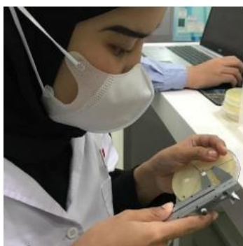
Gambar 4. Pembacaan hasil dengan jangka sorong
