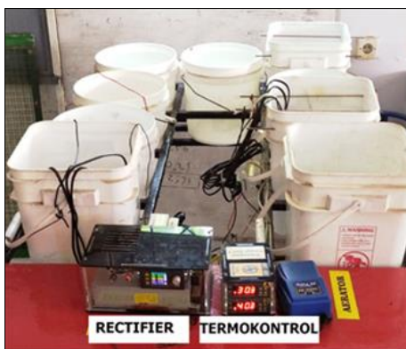
Gambar 10: Alat elektroplating yang telah diseting
