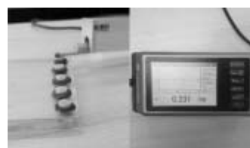
Gambar 5. Pengukuran kekasaran permukaan sampel sesudah direndam dalam ketiga larutan obat kumur.
